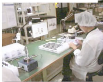
◀ クリーンブース内 コネクター顕微鏡検査
