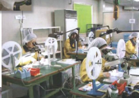
◀ クリーンブース内 コネクター顕微鏡検査
