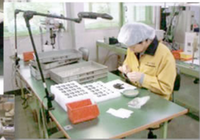
◀ クリーンブース内 コネクター顕微鏡検査
